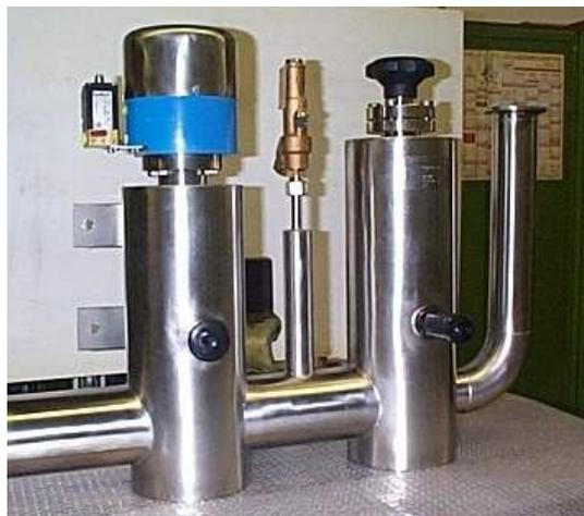
Вентильная сборка с вакуумной изоляцией
